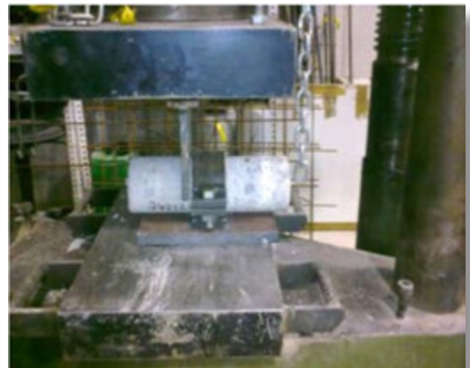
Comprobación de la adherencia entre el pavimento existente y el refuerzo
